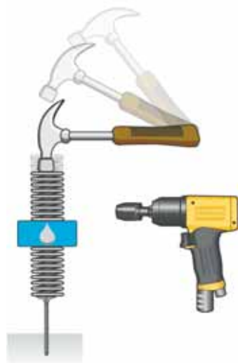
Principe des outils à impulsions.
